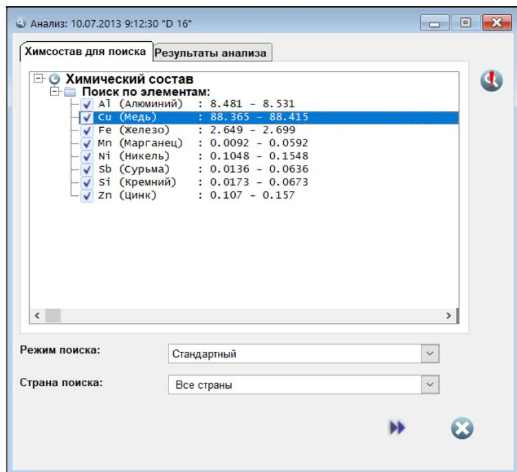
**Рис. 6.4.** Процедура настройки поиска в автоматическом режиме
