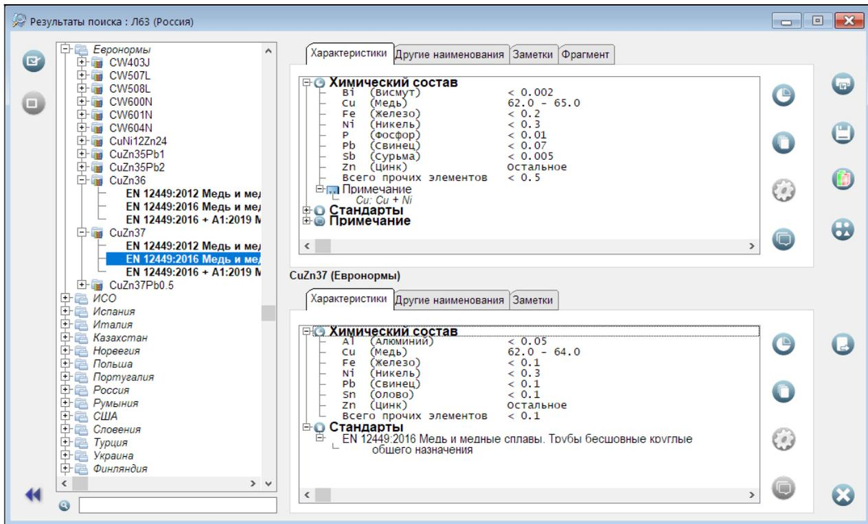
Рис. 4.9. Результаты поиска путем сравнения химических составов
