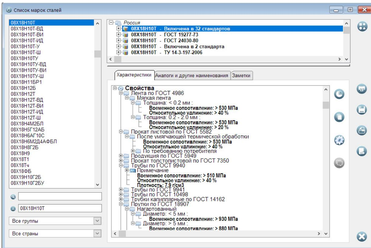
Рис. 5.3. Просмотр информации о стали. Механические свойства
