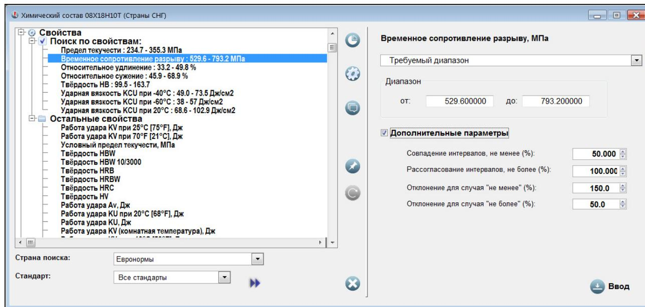
Рис. 5.8. Экспертный режим. Настройка поиска путем сравнения свойств
