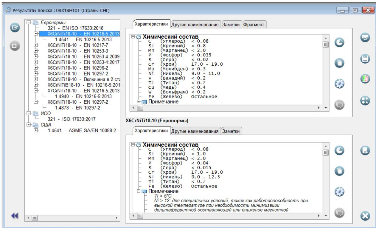
**Рис. 5.10. Результаты поиска путем сравнения химических составов и свойств**
