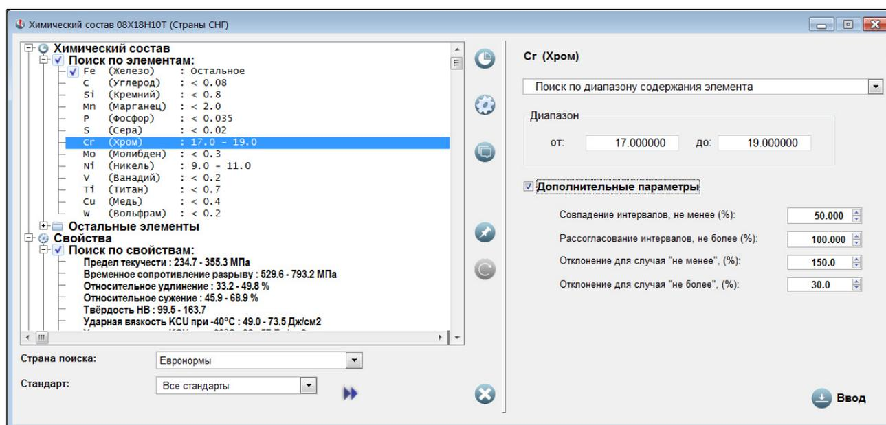
Рис. 5.7. Экспертный режим. Настройка поиска путем сравнения химических составов
