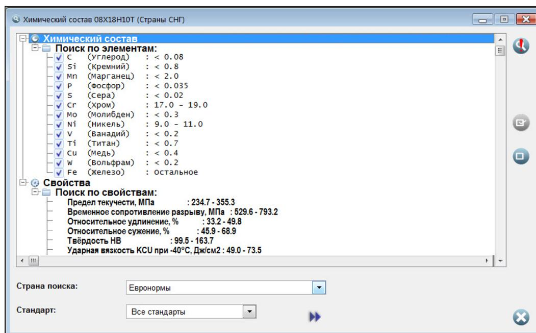
Рис. 5.6. Поиск путем сравнения химических составов и механических свойств. Автоматический режим
