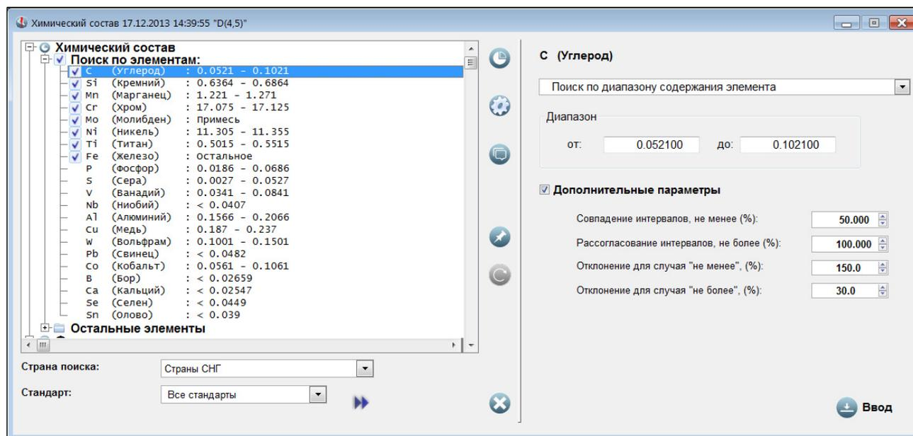
Рис. 4.5. Поиск в экспертном режиме по результатам измерений спектрометра
