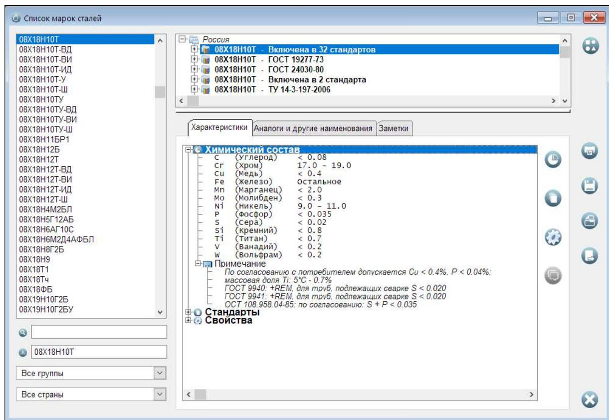
Рис. 5.2. Просмотр информации о стали или сплаве. Химический состав
